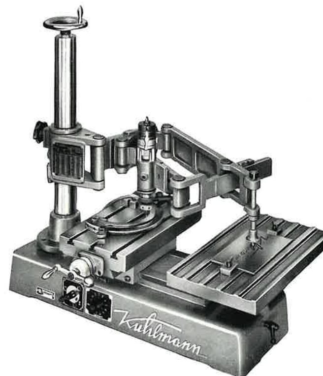
Bild 16 Elektro-Signiermaschine ESM (Sonderausführung), Beschriften einer Lehre
